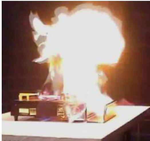
図1 カセットボンベと本体との結合部からのガス漏れによる爆発（再現実験より）
