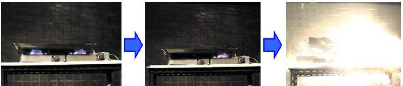
図2 放射熱によるカセットこんろの爆発（再現実験より）
